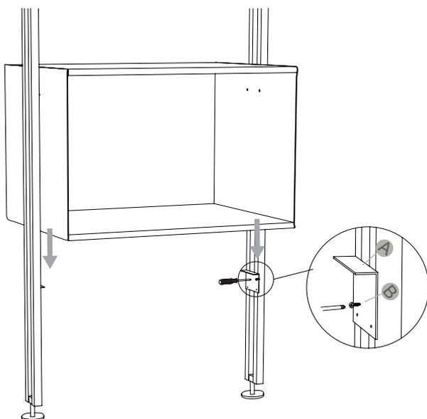
Procedere con il fissaggio utilizzando le viti in dotazione, una volta fissata è possibile svitare e rimuovere i supporti ad "L".
