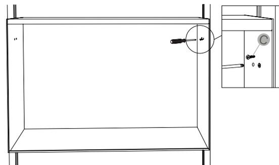
NB: I supporti ad "L" sono forniti esclusivamente per agevolare il montaggio, NON SONO NECESSARI PER LA TENUTA DEL CONTENITORE.
